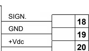
Conectar el cable de SIGNAL del encoder al borne 18 de la regleta de bornes.
