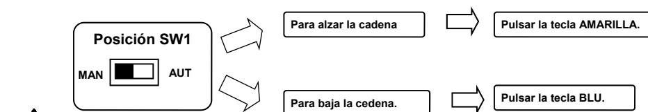
**ATENCIÓN: La reactivación automática (AUT) implica la utilización de la posición alcanzada como posición de cerrada total.**
