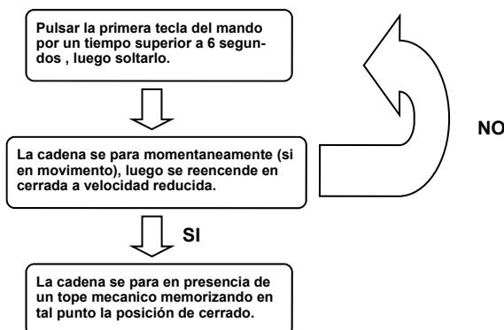
**ATENCIÓN:** Durante la operación de resincronización, la intervención de la seguridad anti-aplastamiento viene interpretada como identificación de la posición de cerrado.Para evitar la intervención involontaria, la sensibilidad de la misma resulta muy reducida respecto a las condiciones de normal funcionamiento.
