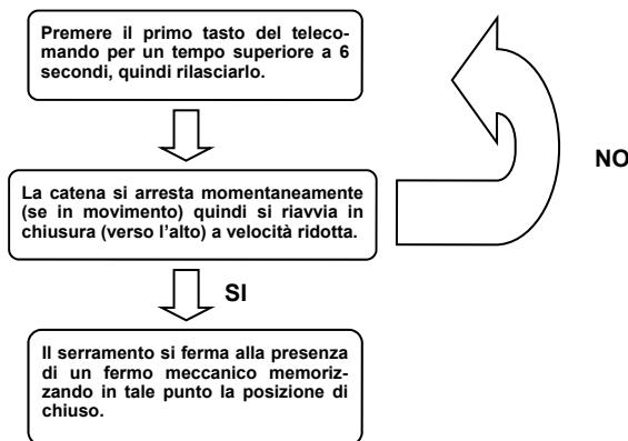
**ATTENZIONE:** durante l'operazione di resincronizzazione l'intervento del sensore viene interpretato come identificazione della posizione di chiuso. Per evitarne l'intervento involontario la sensibilità della stessa risulta notevolmente ridotta rispetto alle condizioni di normale funzionamento.
