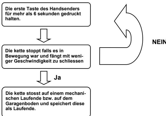
**Während der Widersynchronisierung wird das SENSE als geschlossene Position interpretiert. Um ungewünschten Betrieb zu vermeiden, wird die Empfindlichkeit stark reduziert.**
