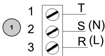
Collegare il cavo di alimentazione tra i morsetti 1, 2 e 3 della centralina se si utilizza un'alimentazione trifase 400 Vac.
